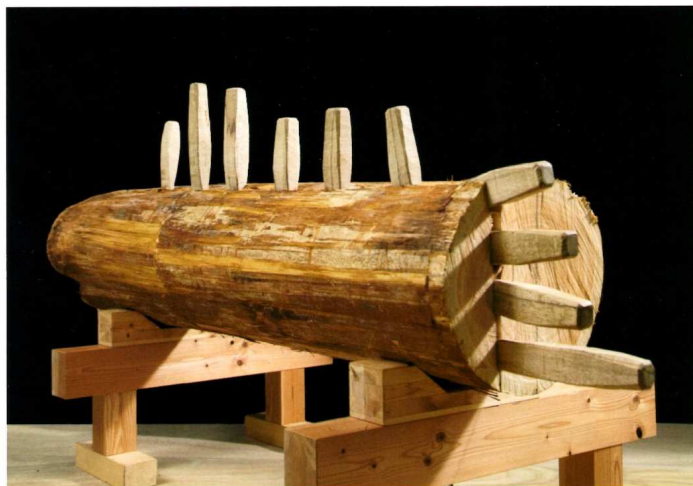
古代の打割製材を検証する実験（丸太から板をつくる）
