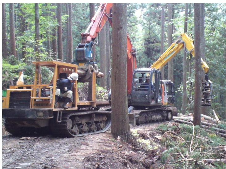
玉切りした間伐材を **グラップル** で掴み、**フォワーダ** に積み込む作業。
