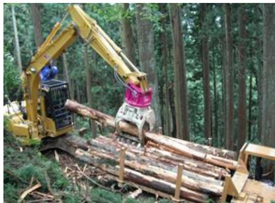
油圧ショベルにグラップルヘッドを装着した機械で、活躍する場所は多く、林内での作業（ハーベスタで伐倒した木の集材作業やフォワーダへの積込）はもちろん、土場から販売先への輸送トラックへの積込作業にも使用します。
