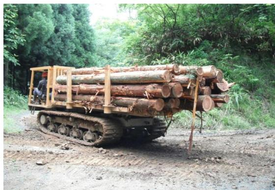
フォワーダ(Forwarder)とは、英語のForward: 運搬するという意味通り、ハーベスタ等で玉切りされた丸太を荷台に積み輸送するまさに「木を運搬する」仕事を主とした林業専用機械です。 比較的傾斜の緩やかな林地では、ハーベスタとフォワーダの連携により従来よりも大幅な工程増と労働力の軽減が図られています。
